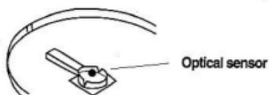
Отодвиньте устройство подальше от солнечного света и окон. Прямой солнечный свет может повлиять на нормальную работу оптических датчиков в чаше шара.
